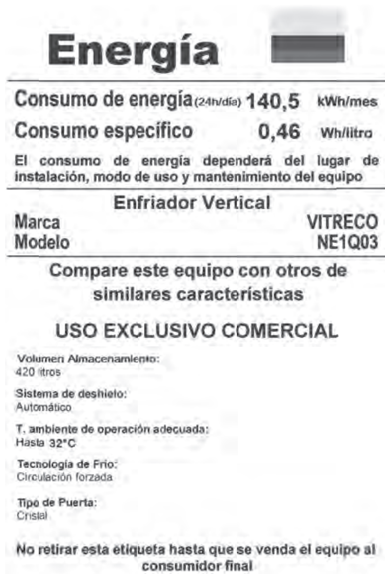
Figura 9.2.5. Ejemplo de etiqueta para enfriadores, refrigeradores, congeladores y sus combinaciones de uso comercial
