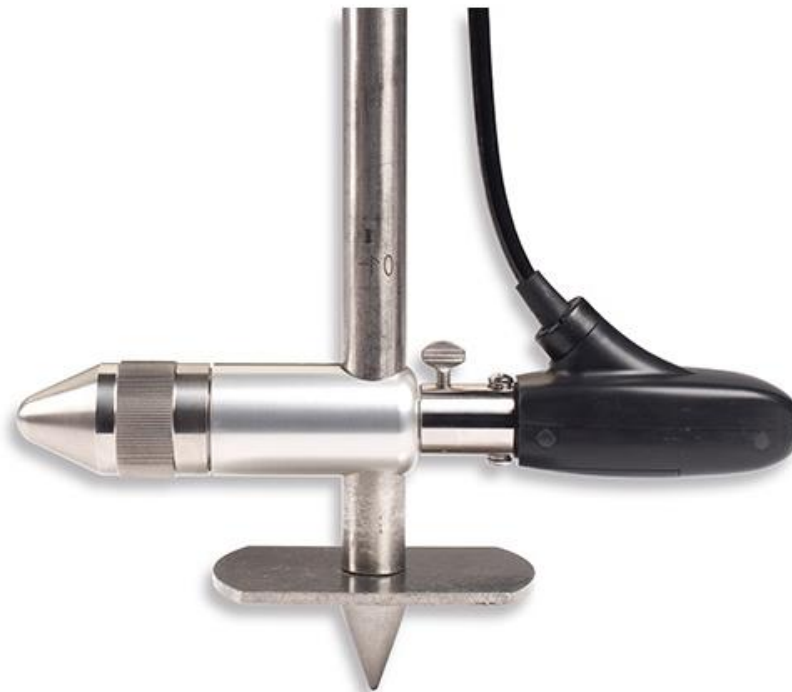
Figura 3. Correntómetro tipo magnético (OTT MF PRO).
