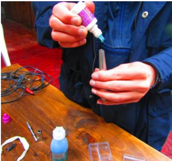
Figura 6. Fases de desenroscado y llenado de aceite de cámara de rotación
