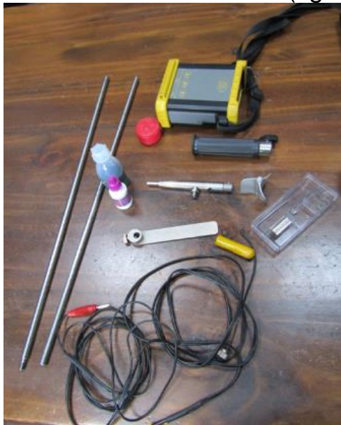
Figura 5. Piezas del molinete previas a mantenimiento antes de su uso.
