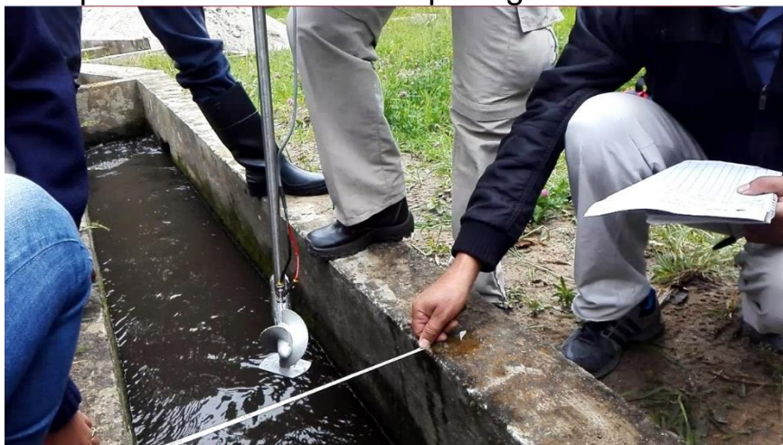
Figura 7. Verificación precisión de molinete en un canal abierto de dimensiones constantes.
