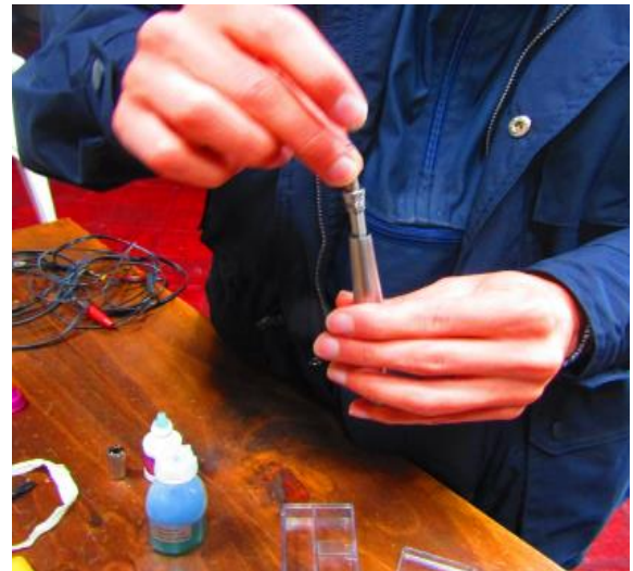
Figura 6. Fases de desenroscado y llenado de aceite de cámara de rotación
