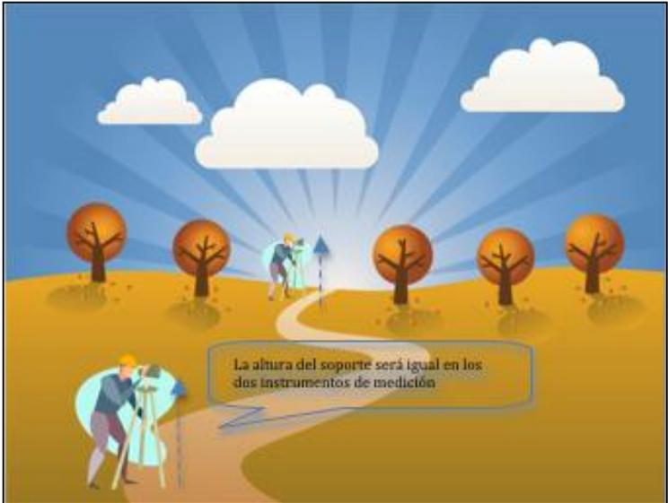
Para determinar la pendiente de un determinado tramo será necesario disponer de dos personas, la primera se ubicará en el punto inicial del sendero con un soporte o base en madera u otro material de 1,50 metros de longitud para instalar el clinómetro en su superficie. A su vez, la segunda persona estará ubicada en
