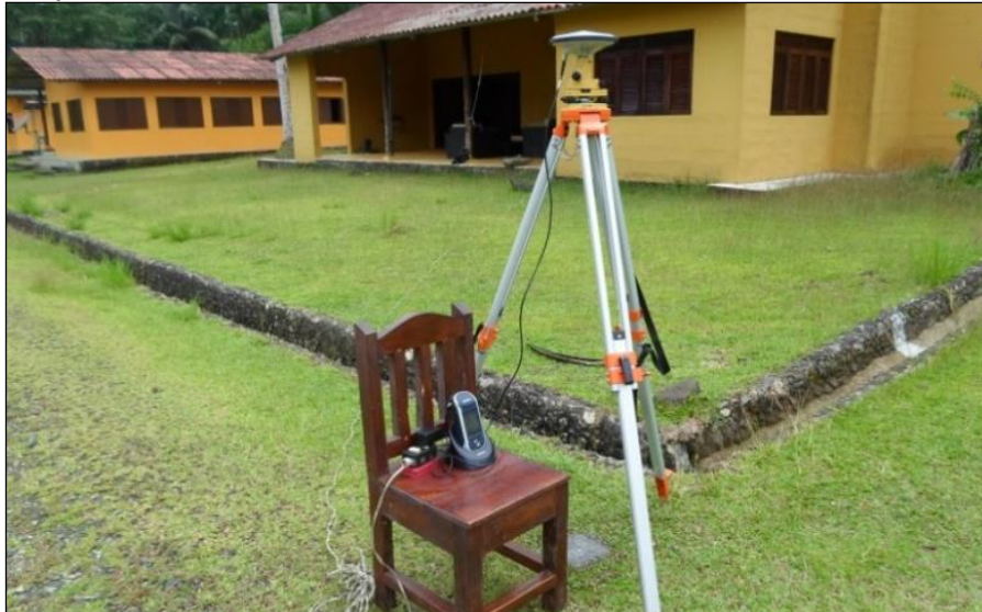
Figura 12: Ejemplo de posicionamiento GNSS en un punto de referencia monumentado en concreto
