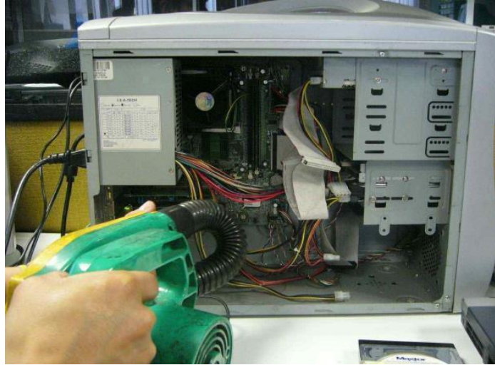
Imagen 6: Inicio de mantenimiento con limpieza
