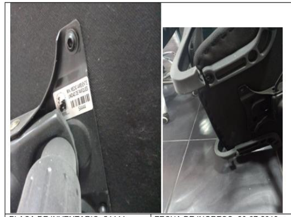
PLACA DE INVENTARIO: 54444 | FECHA DE INGRESO: 23-07-2018 ESTADO: Malo JUSTIFICACIÓN PARA DAR DE BAJA: Daños en su estructura soporte y rompimiento en la unión del soporte del espaldar
